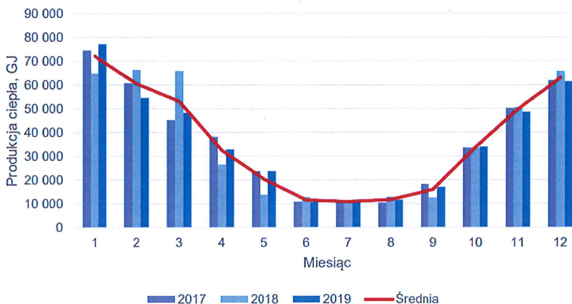
Rysunek 5. Produkcja ciepła przez ciepłownię C13 i C-14 w latach 2017-2019 (Project Energy)
