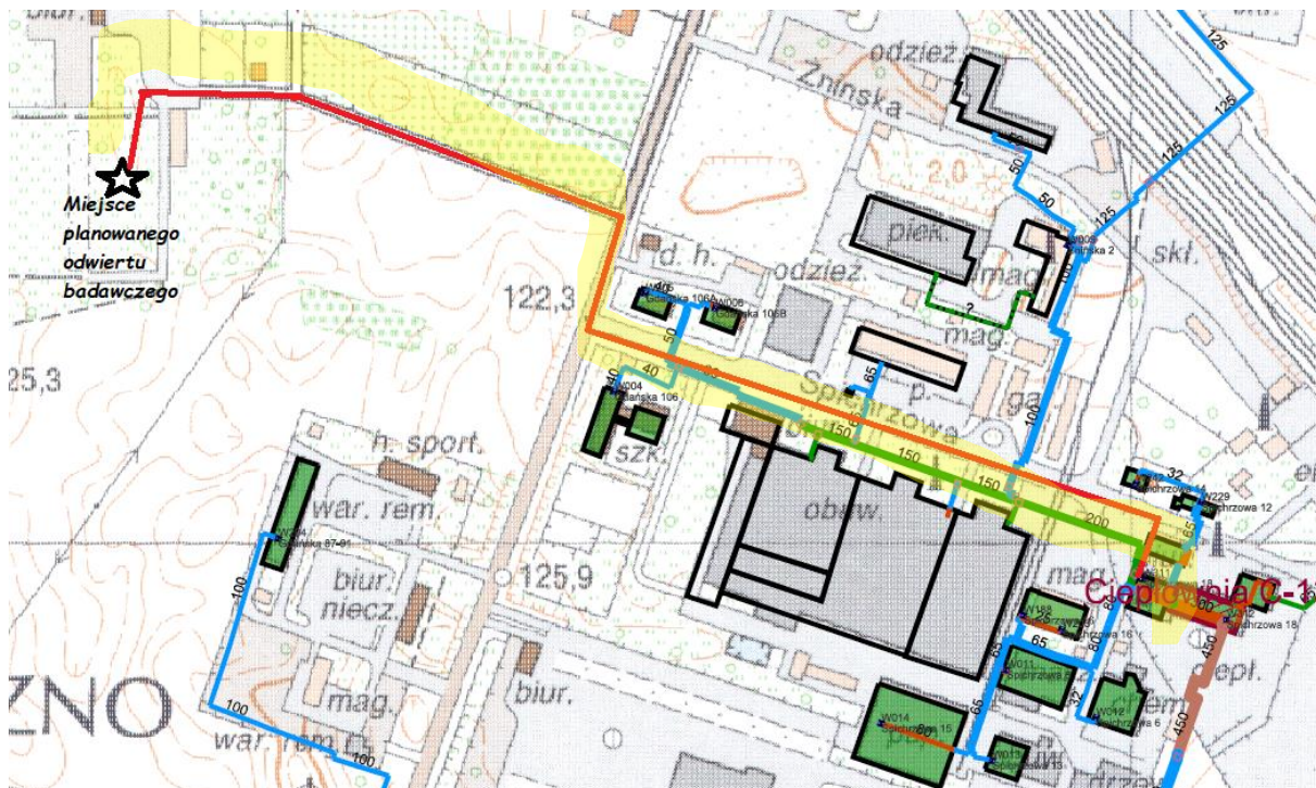
Rysunek 13. Przyłączenie układu geotermalnego do sieci.
